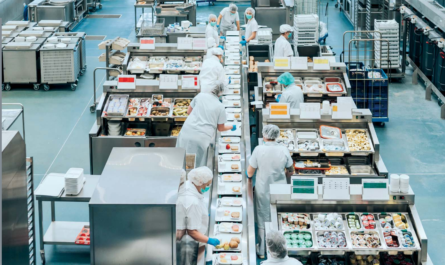
Blick in die Zentralküche des UKS: Mitarbeitende bestücken die Tablettts am vierzehn Meter langen umluftgekühlten Portionierband. Dieses Verteilsystem ist das Herzstück der Küche und eine einzigartige Konstruktion. Seitlich befinden sich die farblich markierten Stationen mit unterschiedlichen Lebensmitteln. FOTO: DX Media
